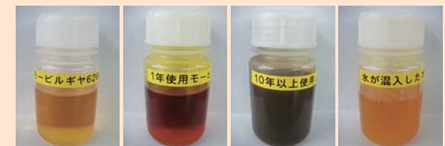
KOMORIの指定潤滑油 1年使用後の指定潤滑油 10年以上継ぎ足しの劣化油 水が入った劣化油
